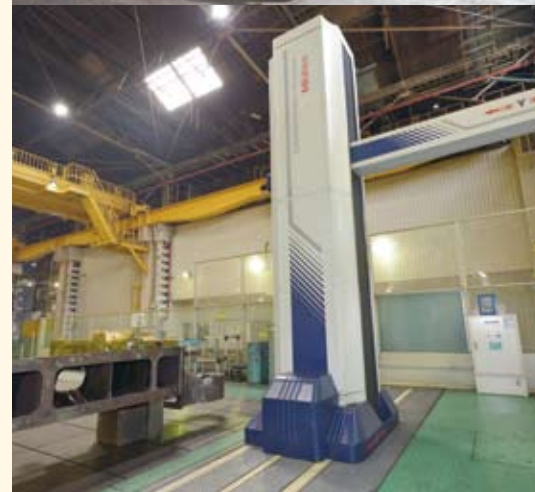
ミツトヨの横型三次元測定機 CARB
