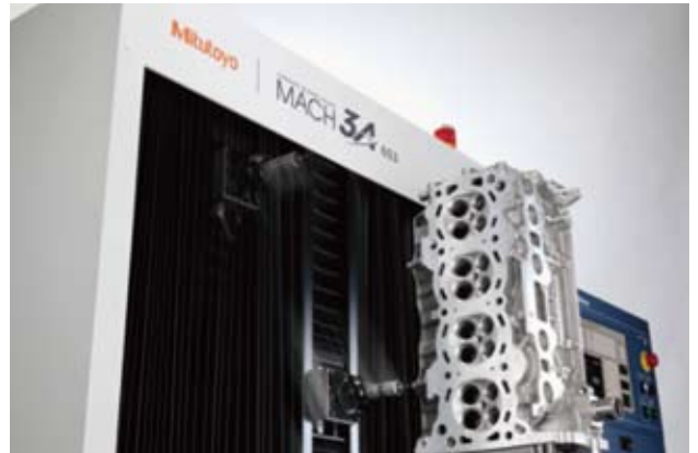
図2 MACH-3Aワーク測定中の様子
